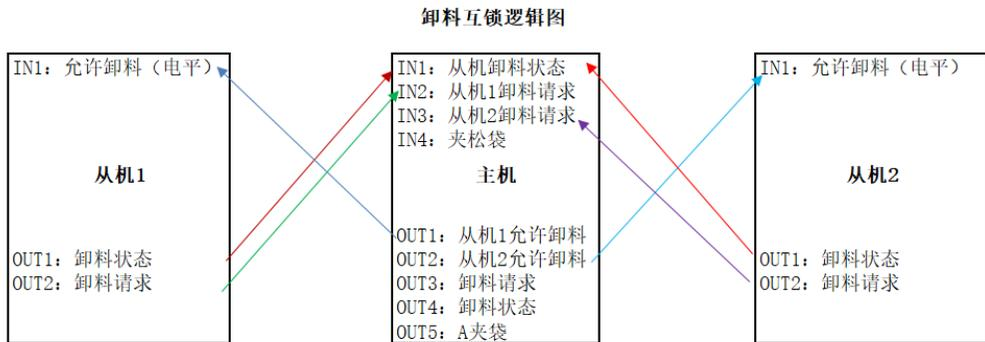
主机：主机卸料互锁开关打开就为主机，控制从机卸料。主机定义夹松袋，处理夹松袋逻辑。
